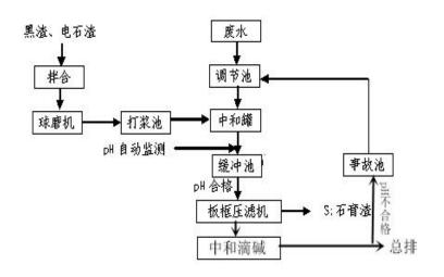
废水处理工艺流程 4.5.2-1
