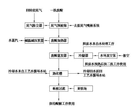
废酸循环利用项目工艺流程框图
